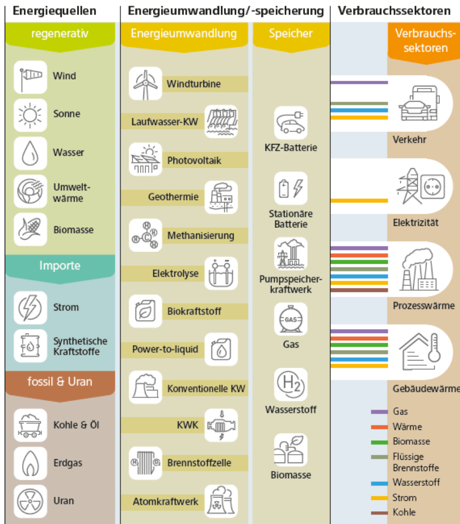
Abbildung 50: Schematische Darstellung des Modells REMod (KW: Kraftwerk, KWK: Kraft-Wärme-Kopplung, [ISE3]).
